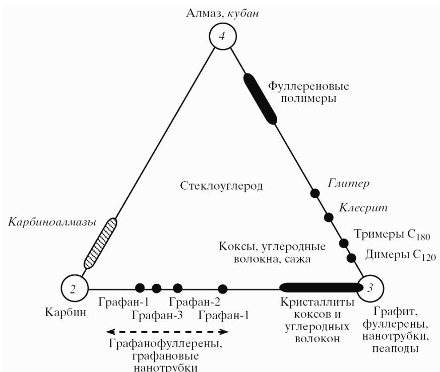
Рис. 1.2. Конфигурационная схема структурной классификации аллотропных модификаций углерода [12]
