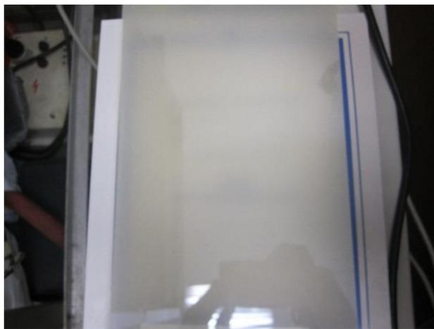
*Рисунок 4.16 — Электрохромная оптическая ячейка в непрозрачном состоянии.*
