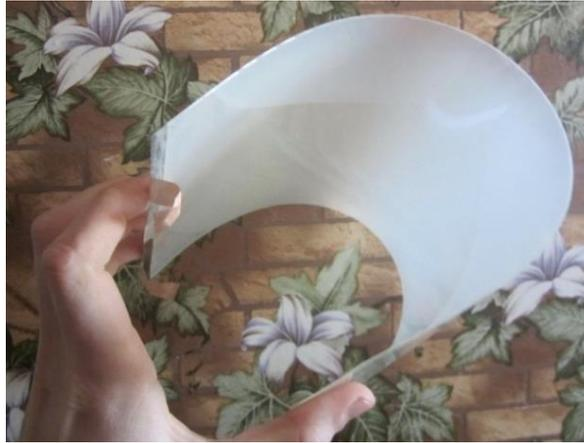
*Рисунок 4.15 — Фотография электрохромной оптической ячейки, изготовленной на гибкой подложке.*
