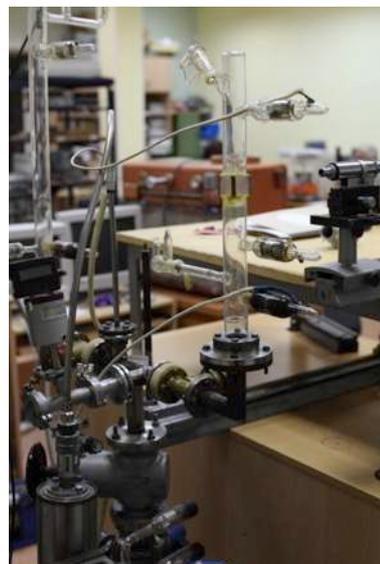
**Рис. 20** Лабораторный стенд экспериментальной установки для исследования процессов модификации поверхности вещества макрочастиц в плазме инертных газов (НОЦ «ПЛАЗМА»).
