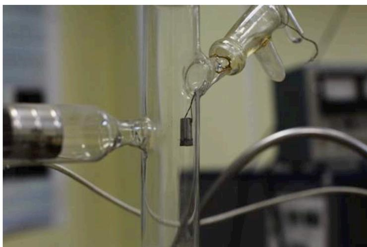
**Рис. 24** Металлический контейнер с мелким ситом, используемый в качестве диспенсера для инъекции частиц в рабочий объем плазмы.
