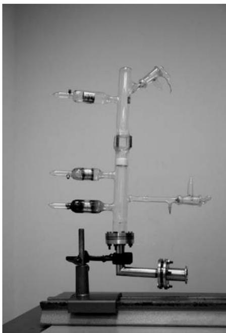
**Рис. 21** Стекло́нная трубка газоразрядного модуля лабораторного макета экспериментальной установки .
