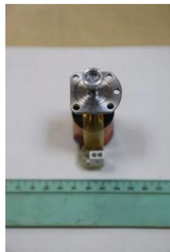
**Рис. 25** Программно-управляемый диспенсер для инъекции частиц в рабочий объем плазмы.
