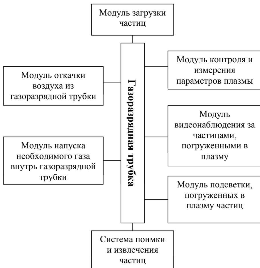
**Рис. 19** Общая схема макета экспериментальной установки.
