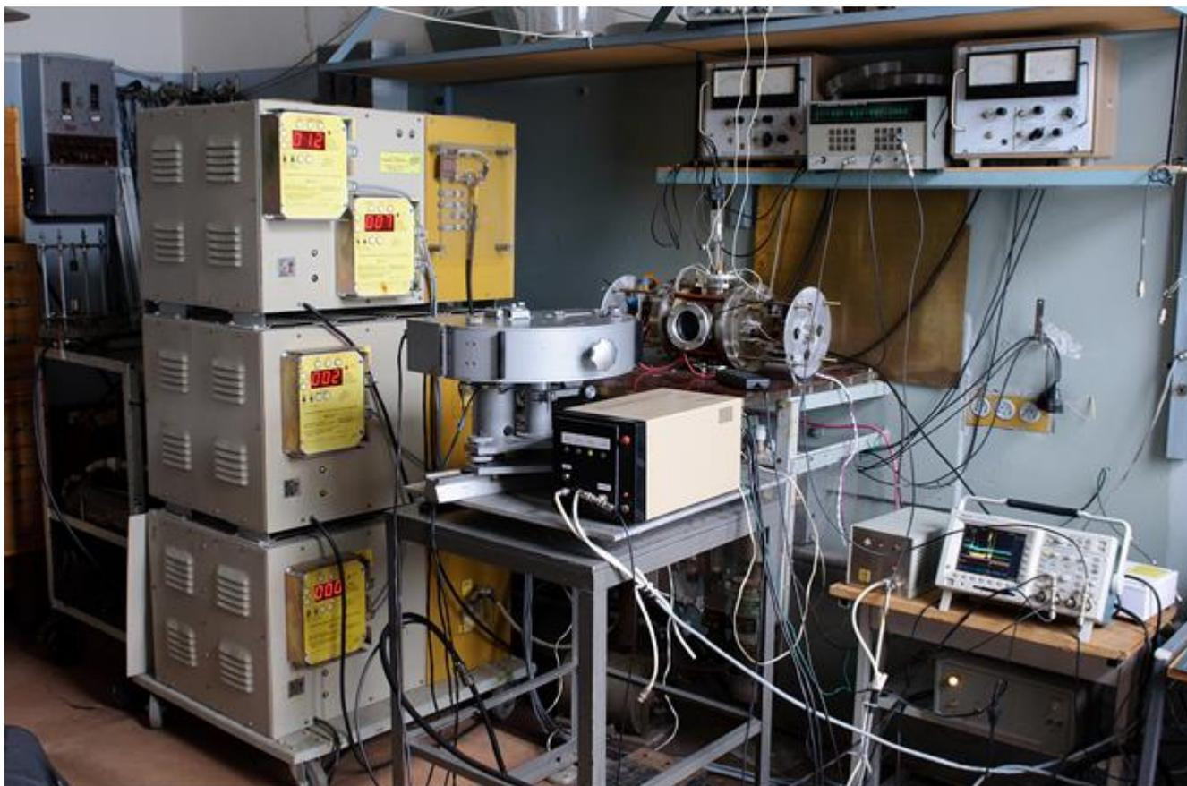
**Рисунок 8.** Фотография экспериментальной установки для исследования динамических характеристик КП и напряжения горения слаботочной дуги в магнитных полях различной ориентации.
